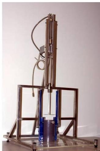
Dispositif de mesure des caractéristiques rhéologiques des déchets solides
