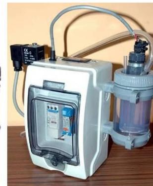
Capteur de mesure volumétrique de production de biogaz
